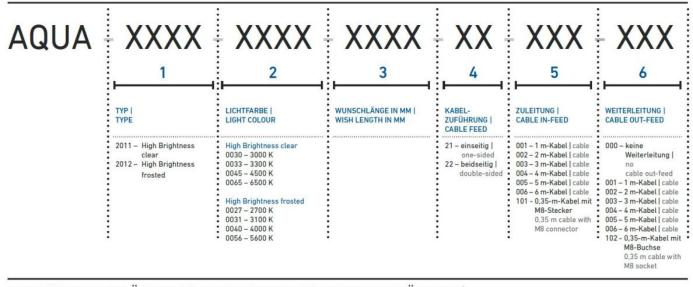
IN INDIVIDUELLEN LÄNGEN, MIT BEIDSEITIGER EINSPEISUNG ERHÄLTLICH | AVAILABLE IN INDIVIDUAL LENGTHS, WITH OPTIONAL IN-FEED ON BOTH SIDES
