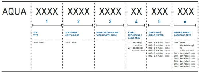
IN INDIVIDUELLEN LÄNGEN, MIT BEIDSEITIGER UND RÜCKSEITIGER EINSPEISUNG ERHÄLTLICH | AVAILABLE IN INDIVIDUAL LENGTHS, WITH OPTIONAL IN-FEED ON BOTH SIDES AND REAR SIDE
