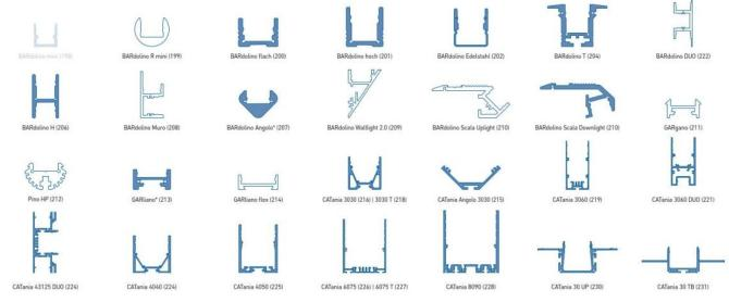
🐵 max. Ta = 25 °C im Betrieb und Montagesituation Aufbau (Einbau bei CATania 30 UP und CATania 30 TB) ansonsten ggf. unzureichende Kühlung | 🕲 max. Ta = 25 °C in operation and surface mounted installation (recessed installation with CATania 30 UP and CATania 30 TB] otherwise possibility of insufficient cooling
