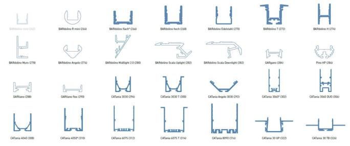
weiß: LED-Punkte sichtbar, kein homogenes Lichtbild | white: LED dots visible, no uniform light distribution blau: homogenes Lichtbild möglich | blue: uniform light distribution is possible
