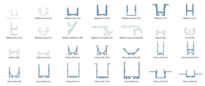
weiß: LED-Punkte sichtbar, kein homogenes Lichtbild I white: LED dots visible, no uniform light distribution blau: homogenes Lichtbild möglich I blue: uniform light distribution is possible \* = eine homogene Lichtlinie ist nur in Kombination mit einer hohen Abdeckung möglich I a uniform light line is only possible in combination with a high diffusor
