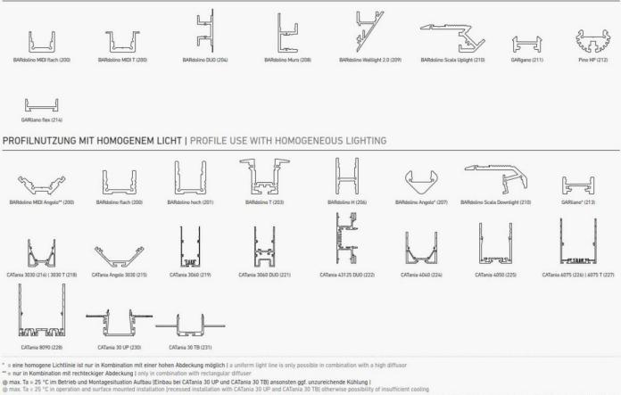
Bitte beachten: Unzureichende Kühlung beschädigt den LED-Streifenl Verarbeitungshinweise zu LEDlight flex siehe www.barthelme.de | Please note: insufficient cooling will damage the LED strips! Processing notes for LEDlight flex see www.barthel
