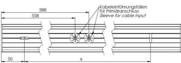
x = Abstand der Befestigungsbohrung ist abhängig von Leuchtenlänge x = Length between mounting holes depends on the length of the luminaire
