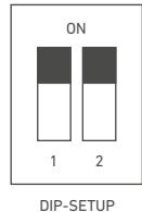
1 - 10 V Steuerspannung – AKTIV | 1 - 10 V control voltage – ACTIVE
