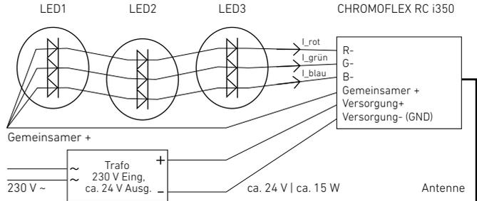
Im obigen Beispiel wurden 3 LEDs verwendet. Mit einem 4-adrigen Kabel lassen sich die LEDs anschließen, wobei eine Ader als Rücklauf benötigt wird.
