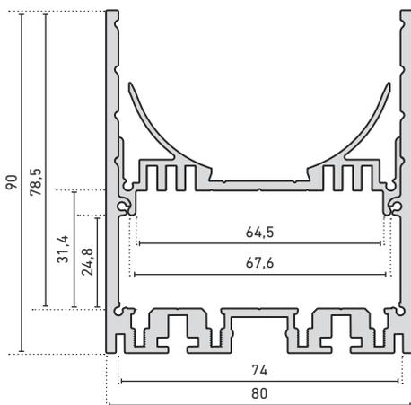
Sowohl Aluminiumprofile als auch Kunststoffabdeckungen haben standardmäßig eine positive Längentoleranz und können somit wenige Millimeter voneinander abweichen. Diese Toleranz kann durch Artikel-Nr. 62397000 (Sägen auf Passmaß) angeglichen werden. | As a rule, both aluminium profiles and plastic covers have a positive length tolerance and can therefore deviate from each other by a few millimetres. This tolerance can be compensated for with article no. 62397000 (cutting to size).
