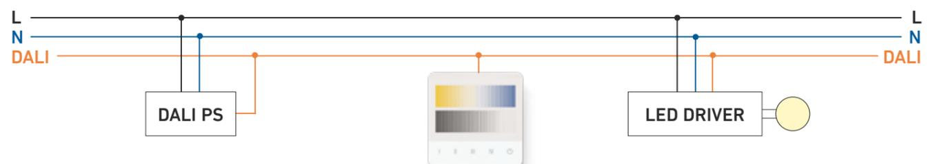
\* Touchpanel erzeugt keine Busspannung, diese muss im System vorhanden sein | Touchpanel does not generate bus voltage, this must be available in the system
