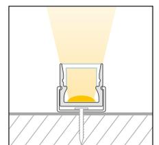
Sowohl Aluminiumprofile als auch Kunststoffabdeckungen haben standardmäßig eine positive Längentoleranz und können somit wenige Millimeter voneinander abweichen. Diese Toleranz kann durch Artikel-Nr. 62397000 (Sägen auf Passmaß) angeglichen werden. | As a rule, both aluminium profiles and plastic diffusers have a positive length tolerance and can therefore deviate from each other by a few millimetres. This tolerance can be compensated for with article no. 62397000 (cutting to size).
