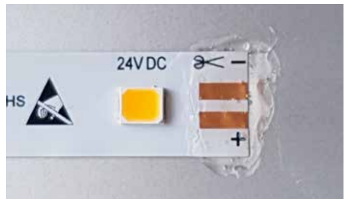
Abb. 2: Flüssiggummi auf Schnittkante
